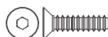
OT242 ⑧ x13 Flat Head Tapping Screw (M3x12) サラタッピングビス
