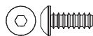
OT242 ⑩ x2 Button Head Tapping Screw (Hex/M3x8) ボタンタッピングビス
