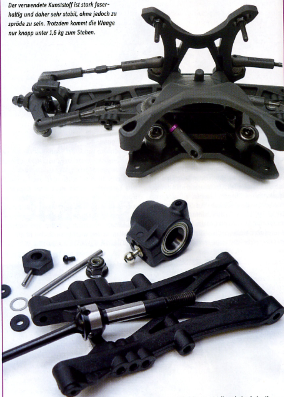
Modernste Bauweise auch bei der CVD-Welle, mit durch das Kugellager gesichertem Pin. Die Felgenmitnehmer werden mit einem durchgehenden Pin von der montierten Felge gesichert.
