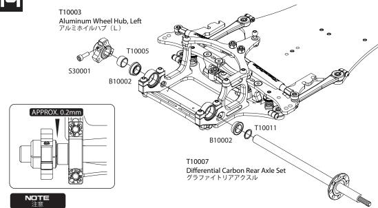
THE AXLE MUST HAS A SMALL AMOUNT OF SIDE PLAY. アルミホイルハブ(L)を取り付ける際には横方向に若干の遊び(0.2mm程度)を作ってください。
