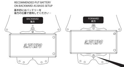
INSTALL BATTERY STOPPER WHEN PUT BATTERY ON FORWARD POSITION
