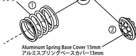
M1.4 x 14 x 20.5mm 5.25T (Green) Spring スプリング
