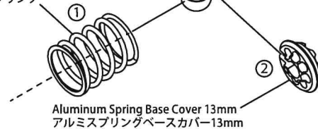
M1.4 x 14 x 20.5mm 5.5T (Orange) Spring スプリング
