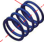
M1.4 x 14 x 20.5mm 5.0T Spring スプリング ①
