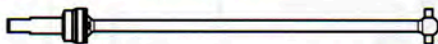
メインドライブシャフト・フロント (90mm) × 1 Main Drive Shaft · Front
