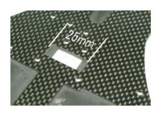
メインシャーシのスパーギヤカバー取り付け部分を写真のようにテーパー状に加工します。細かな寸法に気を使う必要はありませんが美しい仕上がりのためにも現物とあわせながら慎重に加工してください。
