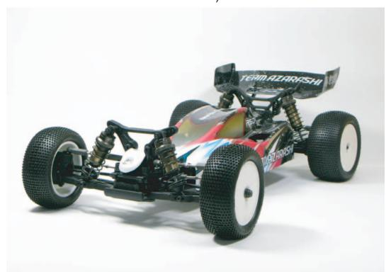
以上でレッドシールの組み立ては完了です。この状態ではレッドシールは非常に軽量で一般的なレース規定の 最低重量を下回ります。各部にウエイトを載せて対応してください。付属のセッティングデータもご参照下さい。
