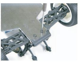
アンダートレイはシャーシ裏面のビスと共締めして固定します。アンダートレイはカットラインに従い切り出したあとフロント側から穴位置を決めていきます。 皿ネジによる固定ですので少しのズレで大きな歪みが出来てしまいます。この作業は慎重に行って下さい。 取り付け穴は現物あわせで穿孔してください。
