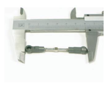
全長63ミリ程度に調整したサーボロッドを取り付けます。
