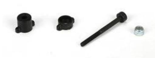
il faut sur la vis de buté bien utiliser du freins à filet qui aura séché avant d'être monté dans le différentiel.
