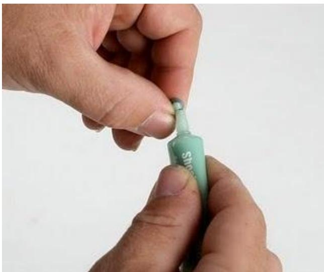
Lors de l'installation de nouveaux joints toriques, il est toujours mieux d'appliquer une petite quantité de graisse pour joint torique (LOSA99208) à l'intérieur de ceux-ci. Cela améliorera plusieurs choses, aidera à la longévité des joints toriques et rendra les axes d'amortisseurs plus libre ce qui améliorera les performances en piste. L'usage de la graisse pour joint torique permettra de réduire les fuites aux niveaux des joints.
