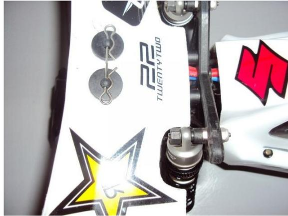
les trous effectués au "rimeur" permettent des réglages très rapidement
