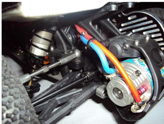
niveau réglage ma base est huile 25 av/ar piston 55 av/ar engrage de base hors amorto légèrement couché à l'arrière
