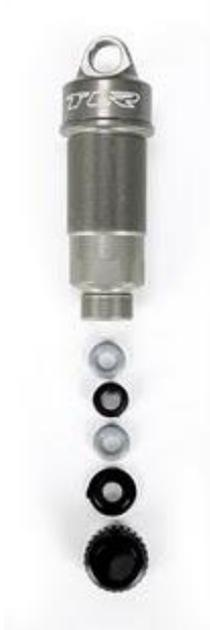
Joint toriques fournis avec le TLR 22. Les joints toriques gris sont bien pour un pilote qui souhaite faire peu d'entretien de ces amortisseurs. Les joints toriques gris sont d'un plus grand en diamètre ce qui permet au joint de se comprimer plus sur le corps de l'amortisseur et fournissent une plus grande étanchéité. Vous remarquerez plus de friction des axes avec les joints toriques gris.
