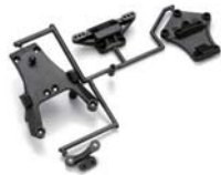
UM501 *630 フロントバルクヘッド Front Bulkhead
