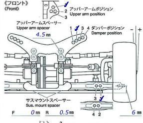
フロントアクスル(ハブキャリア) 2° 4° キャンバー角 -1.5 • Camber angle 車高 4.8 Ground clearance リバウンドストローク Rebound stroke フロントドライブ Front drive One-way Direct スタビライザー ホイールスペーサー Wheel spacer
