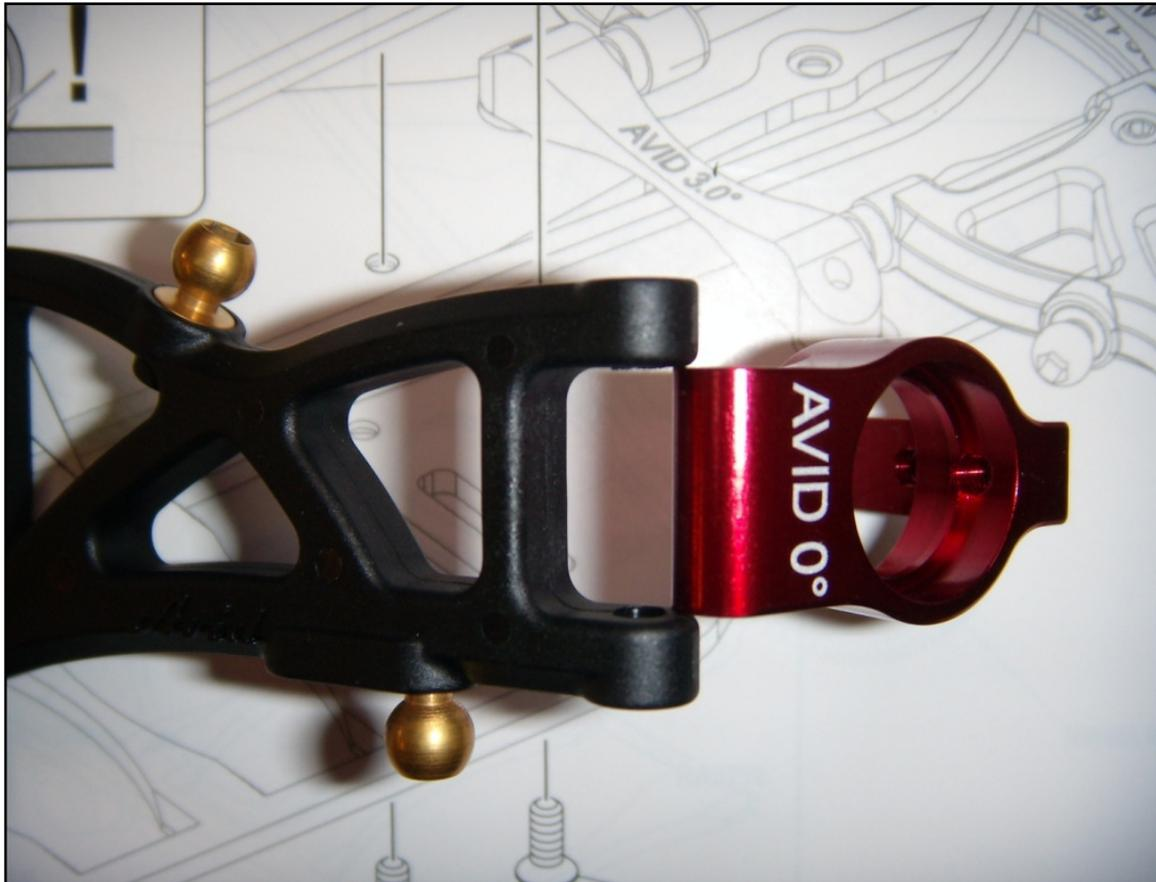
Bien que les éléments du kit soient d'une rare qualité, un léger ajustement des triangles s'impose pour recevoir les fusées arrières. Utiliser un papier abrasif léger et une cale plane pour réaliser l'opération (0,3 mm maxi).
