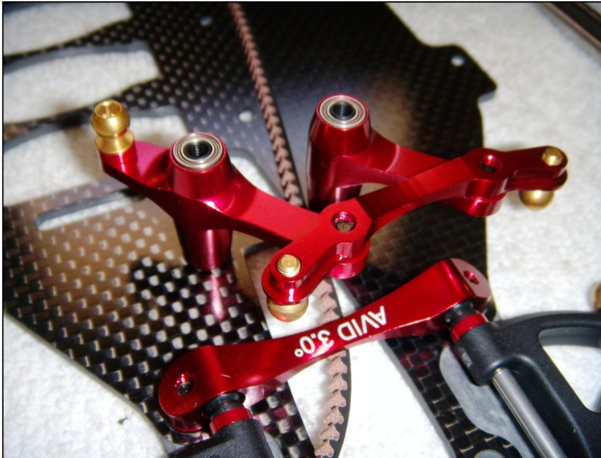
Le système de direction est posé. Veuillez à ne pas perdre les 2 entretoises rouges microscopiques mais également à ne pas les écraser par un serrage excessif. La liberté du mécanisme en dépend.
