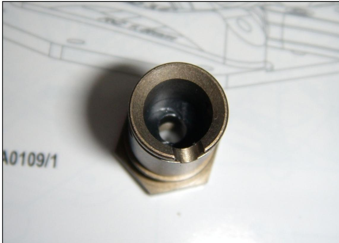
Enfoncer les entretoises plastiques dans le fond de chacune des 4 noix de cardans, elles font office d'écrou Nylstop pour les fixations de roue.
