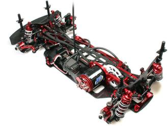
A l'arrière comme à l'avant, vérifier sur une surface plane que les 2 barres antirollis reposent parfaitement à plat sur leurs plans.
