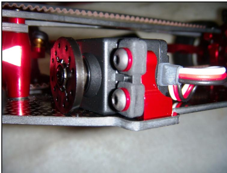
Autre point, la notice indique de monter 4 vis M3x6 pour fixer le servo. Or la longueur est très insuffisante, vue les différents éléments à traverser. Remplacer ces vis par des M3x8 pour les fixations supérieures et M3x10 pour les inférieures. Attention à ne pas toucher les 2 vis de fixation au châssis.
