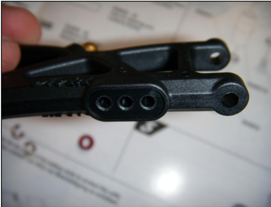
Libérer chaque pièce plastique de sa bavure au point d'injection à l'aide d'une lame neuve. Utiliser une fraise à 45° pour chanfreiner légèrement tous les trous qui recevront les Rotules métalliques.
