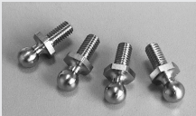
AJ4301N ¥450(税別) メッキジョイントボール 座付きφ4.3:4個入 表面に硬質メッキを施し、振動性と耐久性を向上させたφ4.3mmジョイントボールです。表面硬さHV600位上
