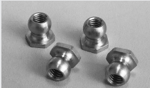
AJ4804N ¥500(税別) メッキジョイントボールφ4.8:4個入 表面に硬質メッキを施し、振動性と耐久性を向上させたφ4.8mmジョイントボールです。表面硬さHV600位上
