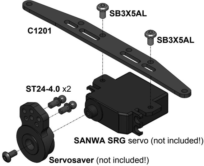
Installation of the standard mini servo.
