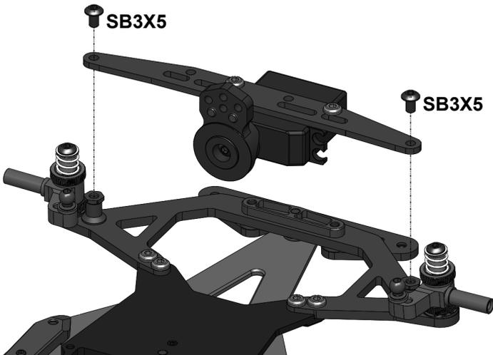
Installation of the 15mm thick mini servo.
