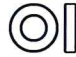
M3 x 6 x 1.5mm Spacer (8) M3 x 6 x 1.5mm スペースサー (8)
